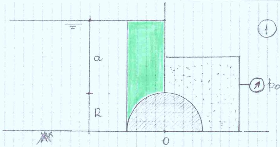
La risultante delle azioni idrostatiche passa per O, perchè tutte le rette d'azione elementari passano per O.
