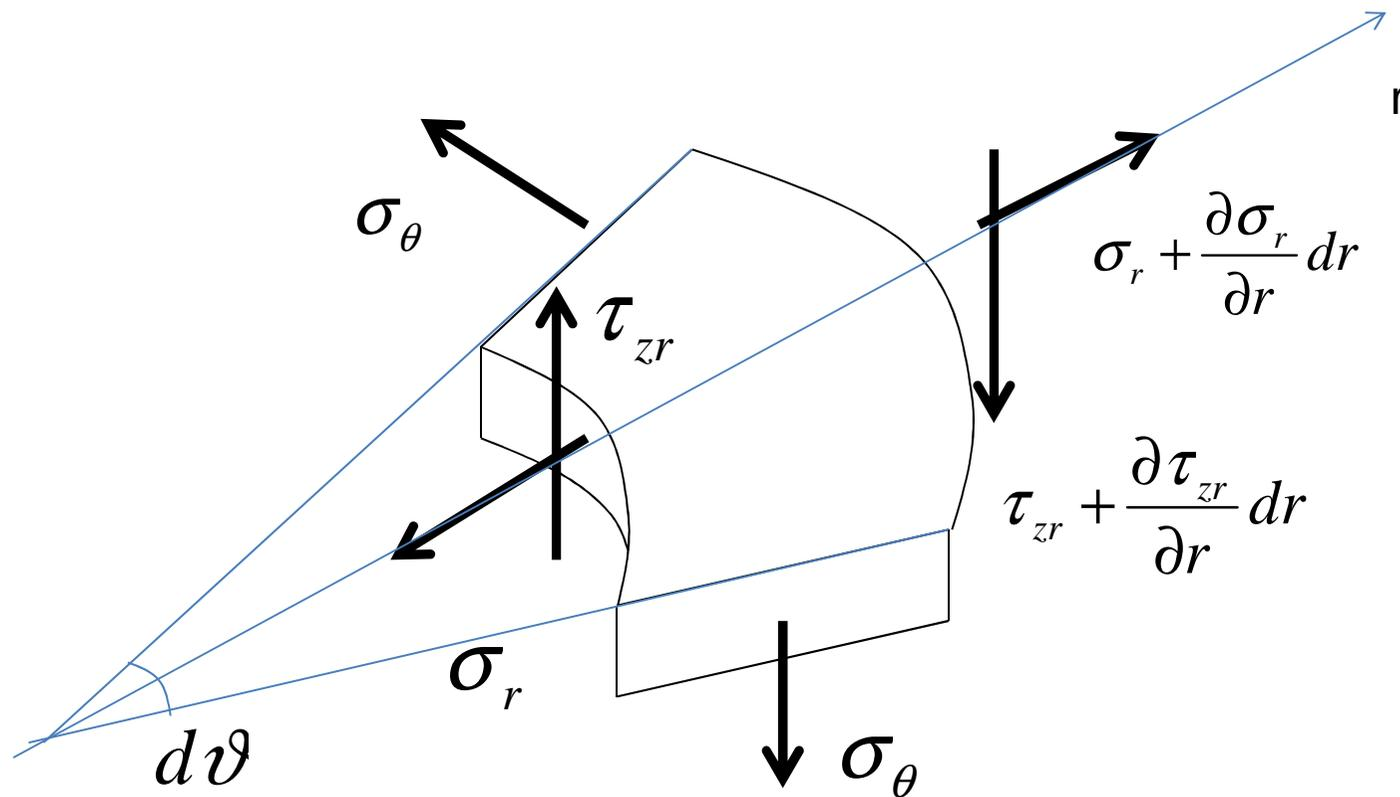
Le componenti di spostamento diverse da zero sono  $u_r$  e  $w$
