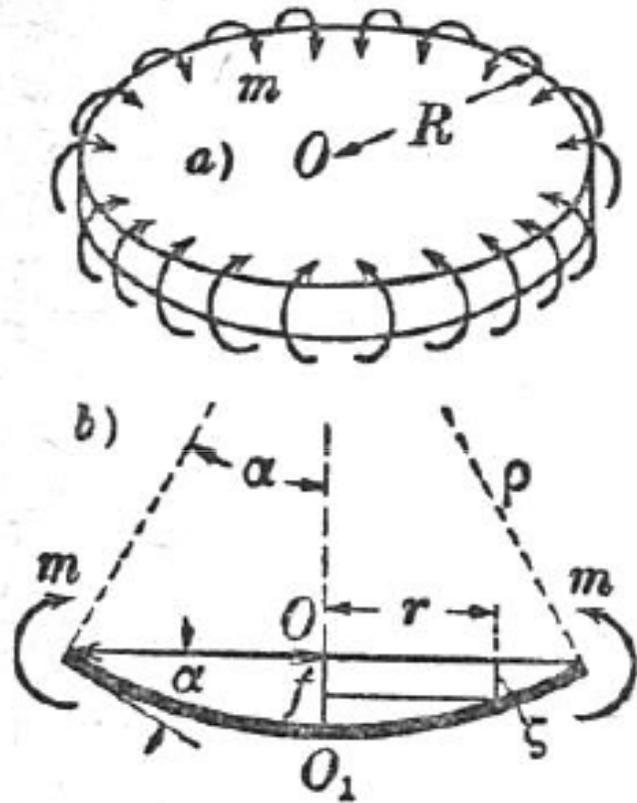
Si definisce stato di curvatura o di flessione uniforme una deformata per cui le curvature sono tutte uguali e la deformata risulta una superficie sferica di raggio  $\rho$
