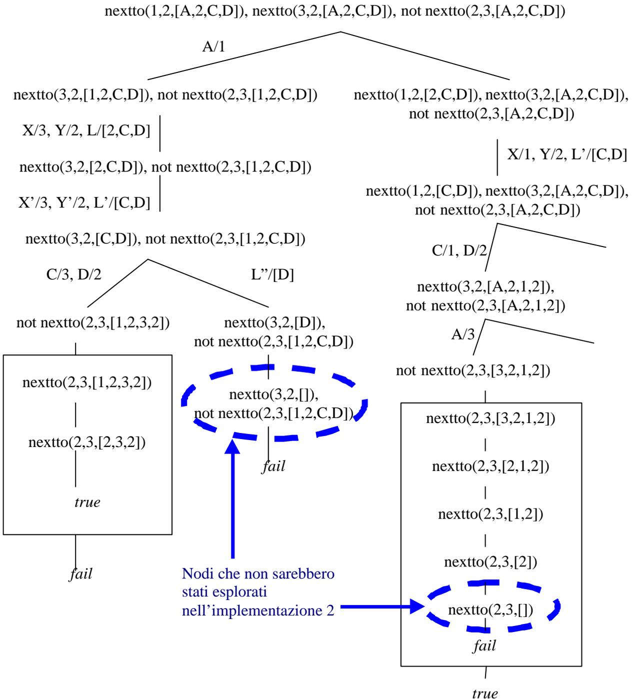
Nella seconda implementazione la semantica dichiarativa non cambia. L'unica differenza è che la seconda clausola unifica solo con atomi in cui il terzo argomento è una lista con almeno due elementi. Per questo la seconda implementazione risulta più efficiente, in quanto fa fallire immediatamente i rami in cui la lista contiene meno di due elementi.
